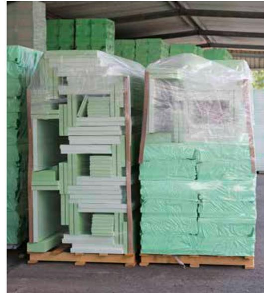
*Die einzelnen Teile einer IsoLohr Bodenplattenschalung werden so verpackt, dass die Handwerker sie auf der Baustelle von der Palette weg in der richtigen Reihenfolge verarbeiten können. Effizienter geht es nicht.*
